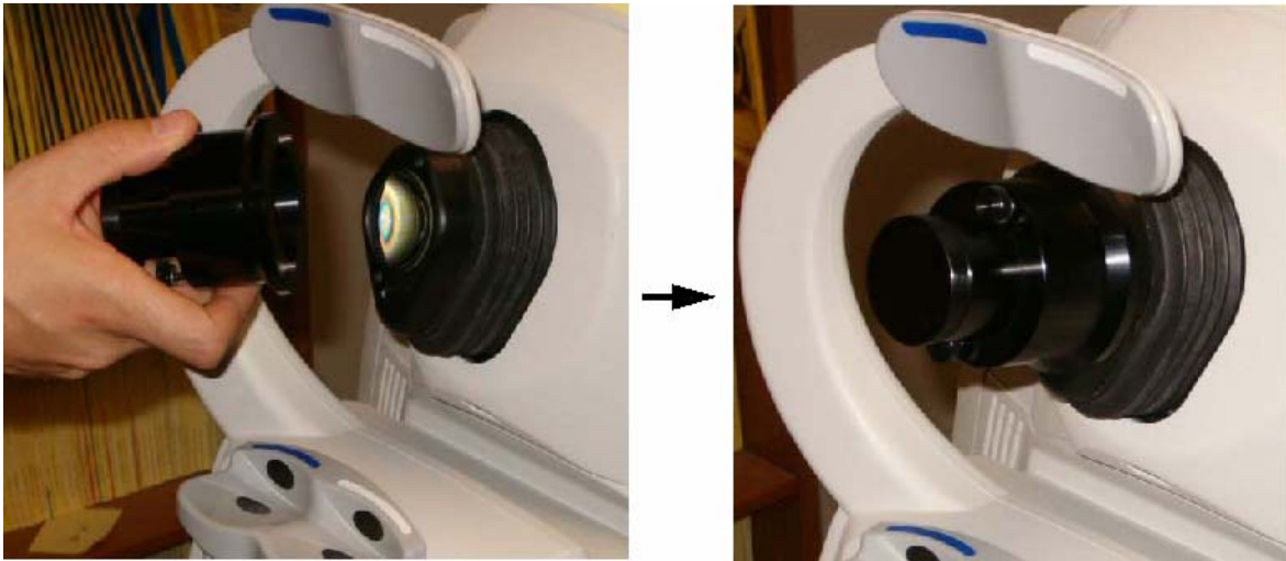
Instalação da Ferramenta Teste de Verificação
